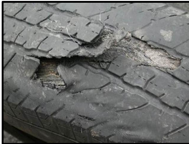
Gambar 8. kerusakan tapak ban bagian depan teriris.
