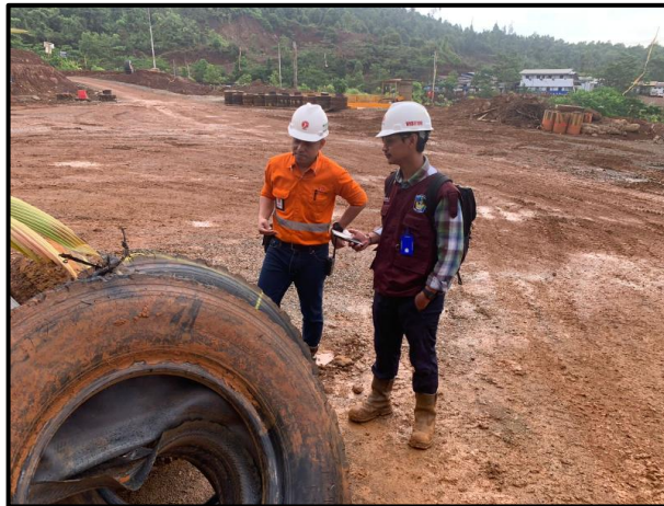
Gambar 10. kerusakan tapak ban bagian depan terkelupas.
