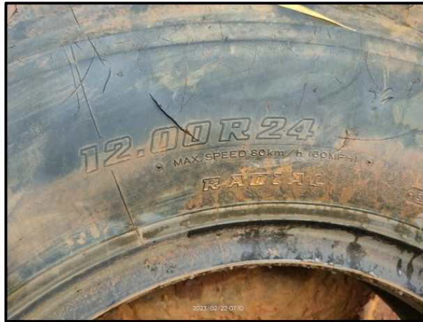
Gambar 7. kerusakan bagian samping teriris.
