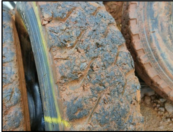
Gambar 9. kerusakan tapak ban bagian depan teriris.
