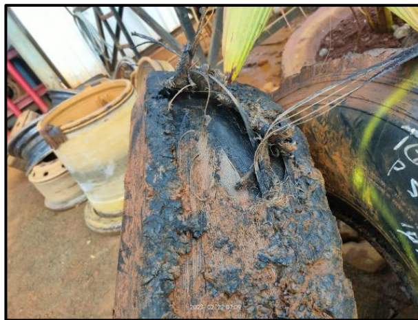
Gambar 6. Kerusakan tapak ban secara tiba-tiba meledak.
