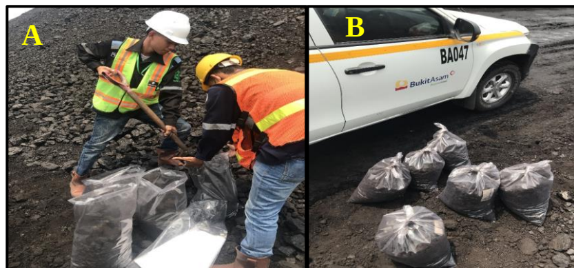
Gambar 3. Pengambilan sampel di stockpile (A) dan pengemasan sampel batubara (B)
