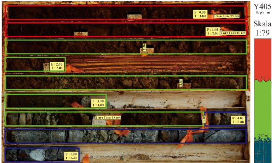
Gambar 10. Kenampakan sampel ( core ) dan interpretasi lapisan pada blok Y dengan batuan dasar peridotit (piroksin)
