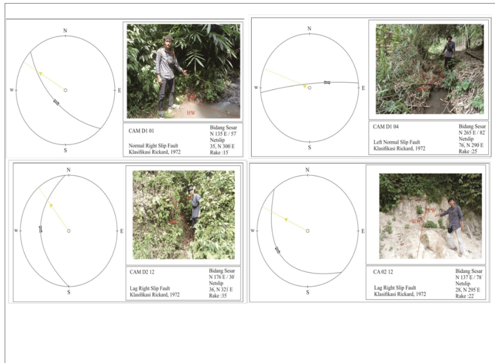
Gambar 11. Struktur geologi daerah penelitian menunjukkan sesar normal
