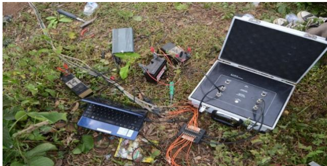
Gambar 11. Alat Geolistrik Multichannel yang digunakan dalam penelitian di TPA Maiwa, Enrekang
