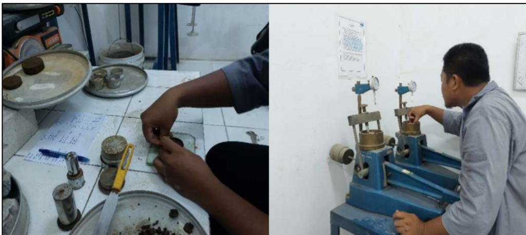
Gambar 3. Kegiatan analisis sifat fisis dan mekanis tanah di Lab. PT Sucofindo
