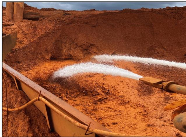
**Gambar 2.** Penyemprotan Material di *Hopper*
