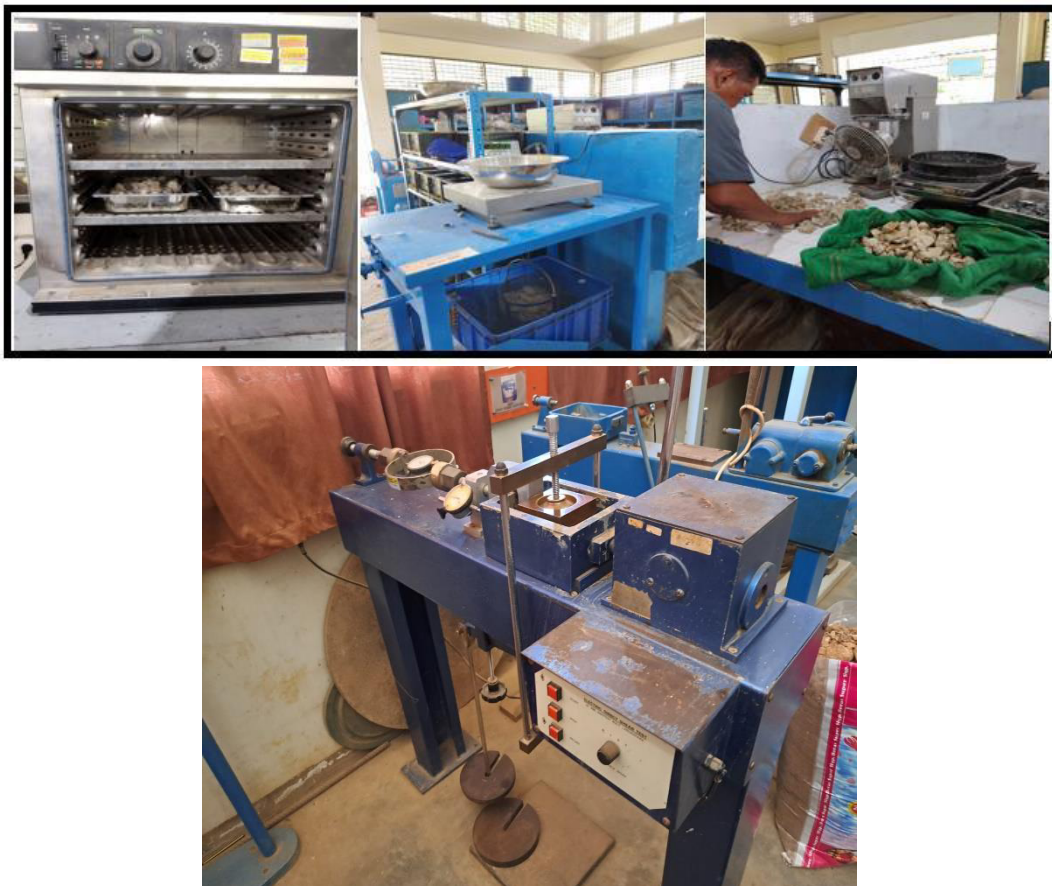
Gambar 3. Pengujian Sifat Mekanik dan Sifat Fisik Batuan Trass PT. Tambang Batuan Trass
