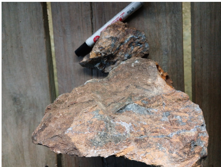
Gambar 5. Sampel yang memperlihatkan keterdapatan mineral antimonium serta mineral kuarsa dalam bentuk vein .
