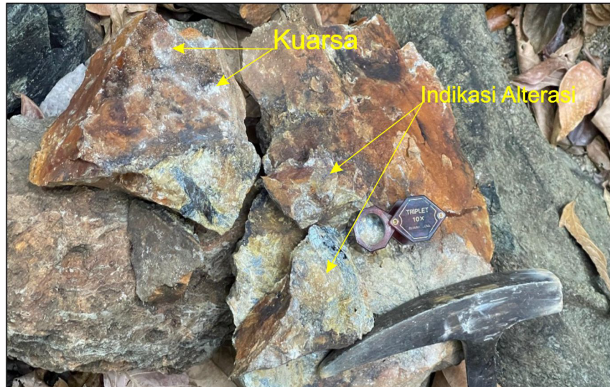
Gambar 2. Sampel batuan yang memperlihatkan indikasi alterasi dan mineral kuarsa
