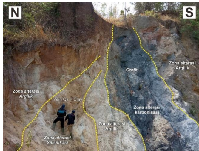
Gambar 10 alterasi argilik yang berkembang di lokasi penelitian, alterasi argilik hadir menyelubungi urat kuarsa dan mineral grafit
