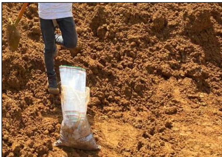
Gambar 1. Proses Pengambilan Sampel Bijih Nikel
