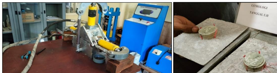
Gambar 3. (a) Alat uji geser langsung Indotest Portable Shear Box RN 140. (b) Kondisi permukaan kekar setelah uji geser
