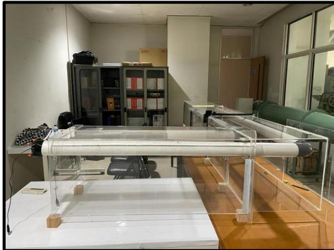
**Gambar 4.** Model Fisik Terowongan Skala Laboratorium Tampak Samping
