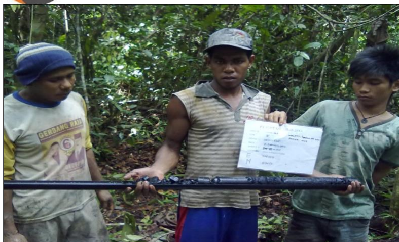
Gambar 1. Coring hasil pengeboran
