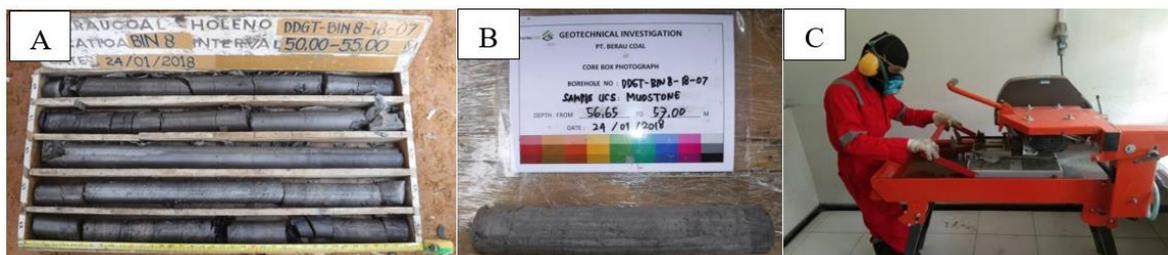
**Gambar 2.** (a) *Core* pemboran geoteknik, (b) Sampel untuk pengujian UCS dan PLI, (c) Proses preparasi contoh dengan *cutting machine*
