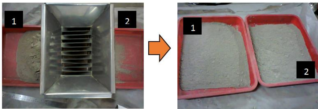
Gambar 2. Sampling dengan splitter box
