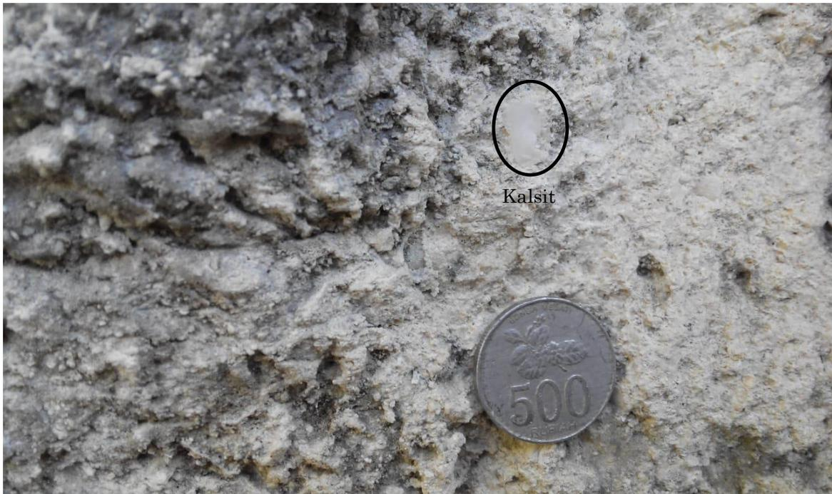
**Gambar 8.** Sampel singkapan batuan C yang mempunyai mineral kalsit
