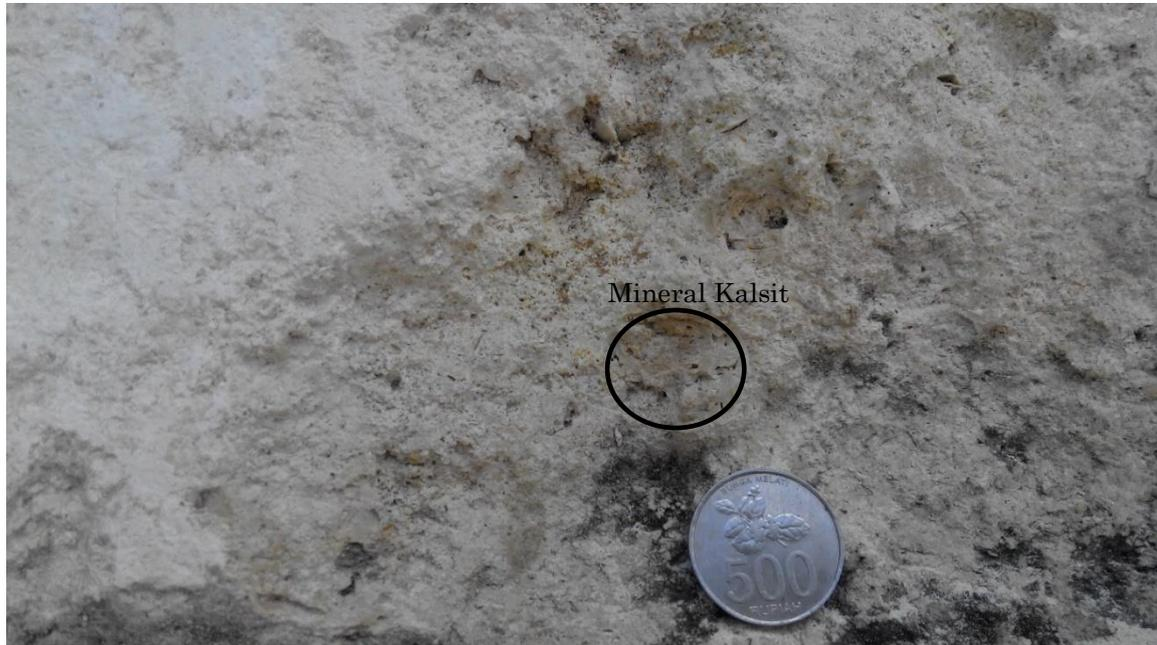
**Gambar 2.** Sampel Singkapan Batuan A yang mempunyai mineral kalsit
