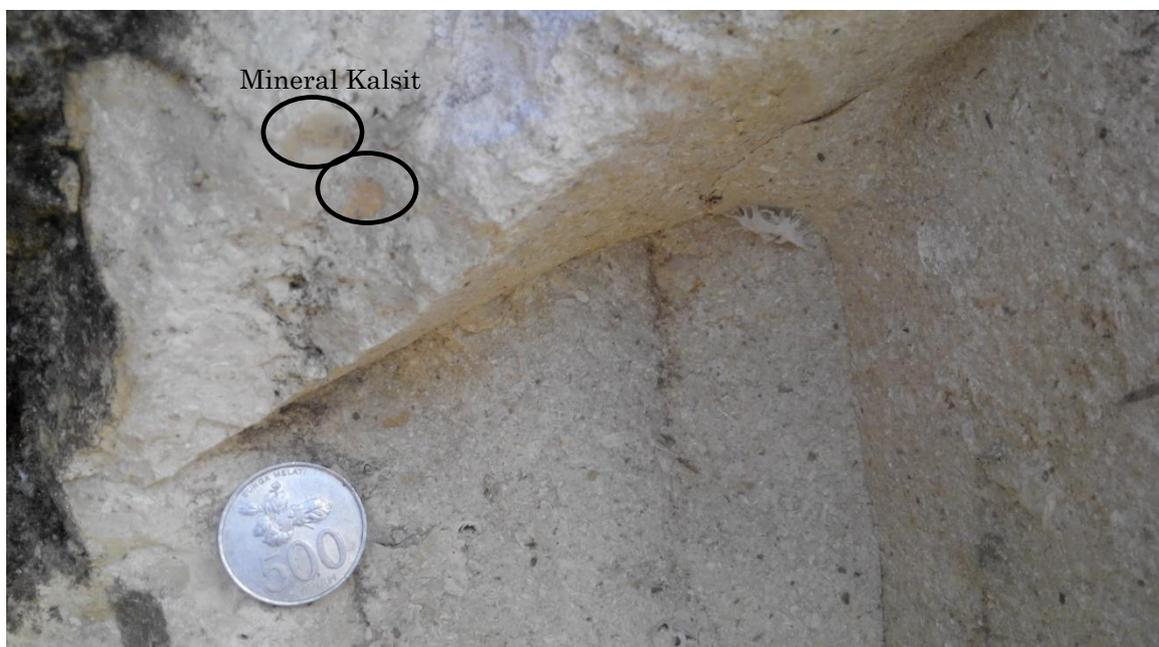
**Gambar 6.** Sampel singkapan batuan B dengan mineral kalsit
