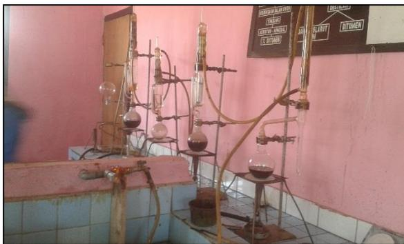
Gambar 1. Alat penentuan jumlah kandungan air dan kadar bitumen.
