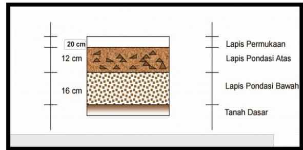
Gambar 6. Lapisan Perkerasan Jalan
