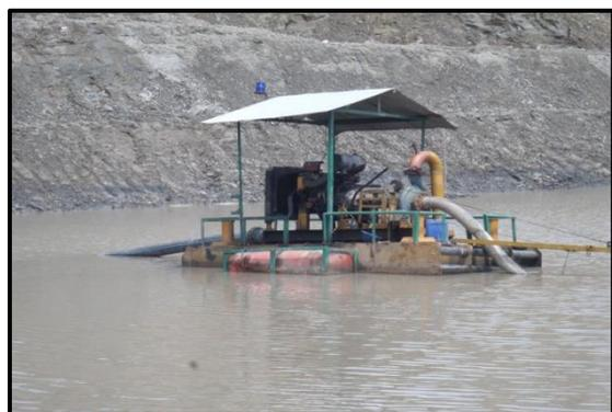
Gambar 2. Pompa Mitsubishi 6D15 yang digunakan pada pit 1 PT. Rimau Energy Mining.
