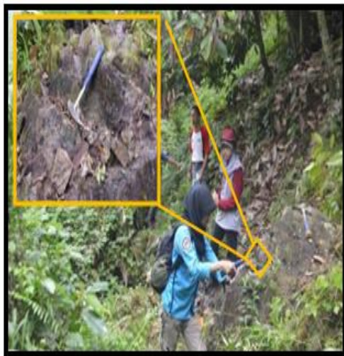
Gambar 8. Kenampakan parit uji lokasi dijumpai mineralisasi galena kompak dan logam ikutannya, memanjang utara – selatan, panjang parit uji 20 m, host rock batupasir abu – abu. lokasi lereng kiri sungai pekadengeran menuju hulu. (kordinat 119° 18' 30.22" E - 3° 22' 8.47" S).
