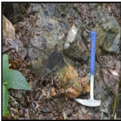
Gambar 6. Kenampakan mineralisasi kompak galena dan ikutannya pada stasiun 11 dijumpai pada batupasir berubah sedang, kompak berwarna abu – abu. Lokasi lereng kiri menuju hulu sungai Pekadengeran.
