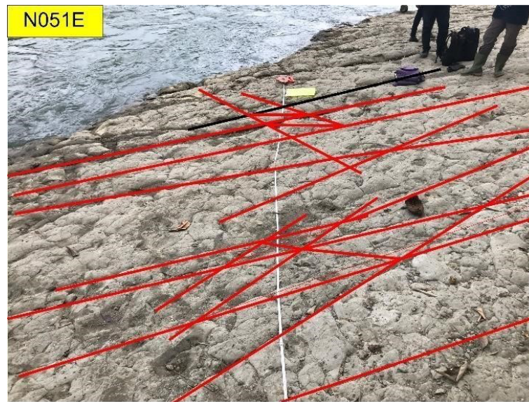
Gambar 8. Struktur Geologi Berupa Kekar Batupasir Mollusca Formasi Simpang Aur pada Lp. 25 didesa Rantau Panjang.
