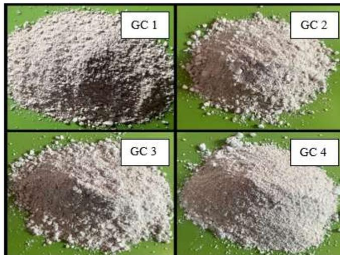
**Gambar 4.** Empat sampel batugamping yang telah dikominusi
