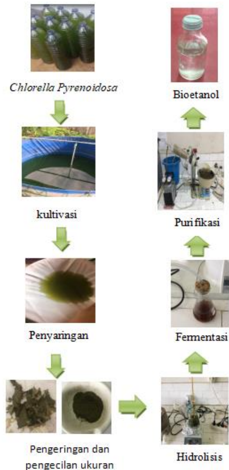
Gambar 1. Proses Pembuatan Bioetanol Berbahan Baku C. pyrenoidosa
