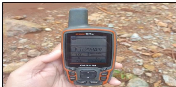
Gambar 3. Koordinat kolam dan elevasi menggunakan GPS Garmin 64s.
