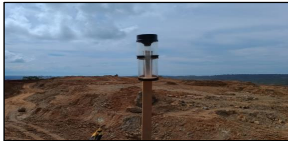
Gambar 1. Kenampakan Alat ukur curah hujan rain gauge
